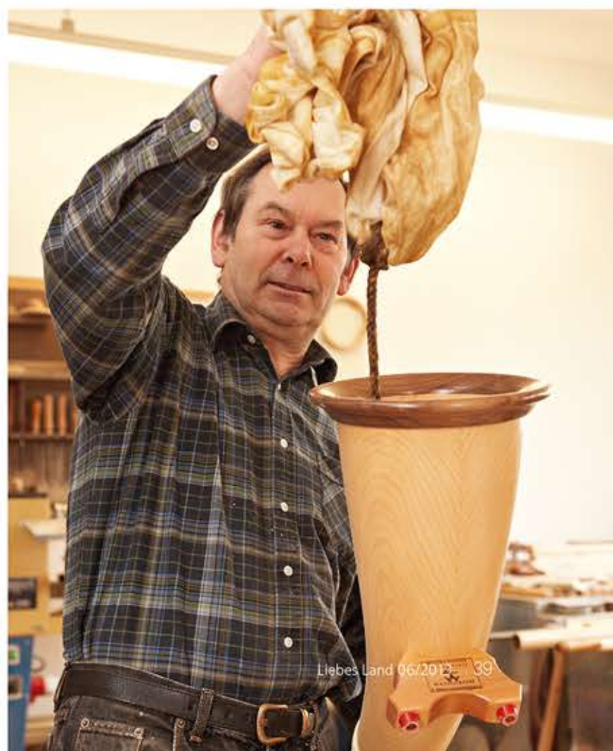
UNTEN Alfons Neumann zieht einen alten Lappen an einem Seil durch das fertige Alphorn, um überflüssiges Öl aus dem Innern zu saugen. So ist das Horn gleichmäßig geschützt
